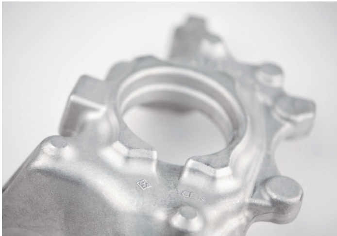
Abb. 1 Wärmebehandeltes Aluminium-Schmiedebauteil (Radträger)
