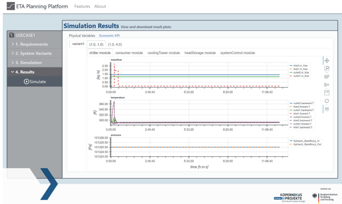
Abb. 6 Visualisierung der strömungsmechanischen Ergebnisse (Massenstrom, Temperatur und Druck)
