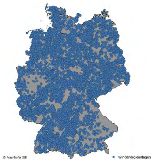
Abbildung 5.1: Standorte für Windenergieanlagen an Land in 2030 und 2045 für das Fokus Wind-Szenario.
